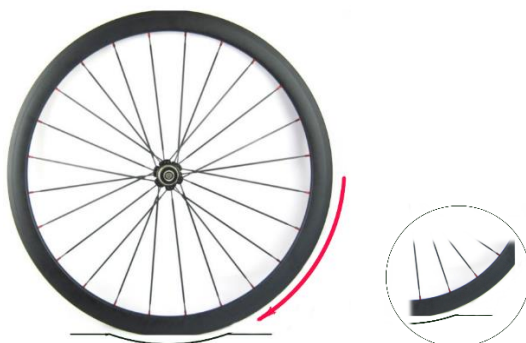
Рисунок 3.31 – Трение качения колеса относительно опоры
